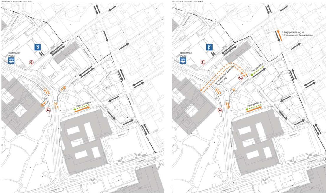
Abbildung 21: Neuer Knoten Gloria-/Plattenstrasse - Varianten: 4-armiger Knoten (links), 3-armiger Knoten (rechts)
